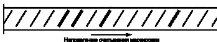
Рисунок 2 — Пример прокатной маркировки предприятия-изготовителя под номером 14
